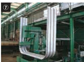
工程⑦ ▶ 両側曲げ完了。ラジアルガレージの基となる1スパンの完了です。
